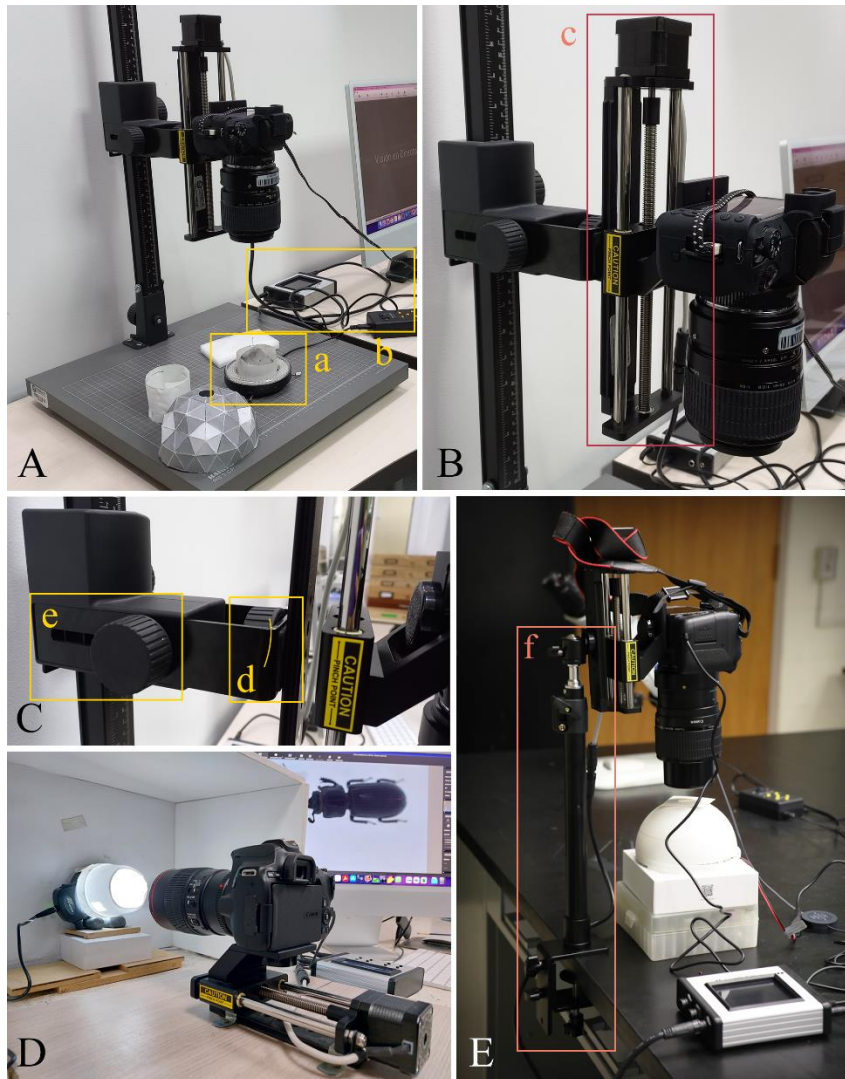
Figura 4. Sistema automatizado de desplazamiento de cámara y lente por medio de un riel motorizado, para la generación de múltiples imágenes secuenciales: A) Soporte para el sistema para posicionamiento vertical. (a) anillo de luz led; (b) Disposición de cables y accesorios del sistema. B) Detalle del acoplamiento del riel (Macro Rail) al soporte. (c) Riel en disposición horizontal. C) Detalle del soporte en el punto de anclaje del riel. (d) Tornillo de ensamble del soporte al riel; (e) Posición retraída del brazo del soporte para disminuir el torque. D) Disposición horizontal del sistema. E) Alternativa para la disposición vertical del sistema, con (f) soporte de prensa de mesa con tornillo. Fotos: J. Cardona-Duque (A-C), L. Jiménez-Ferbans (D) y C. Flórez-V (E).
